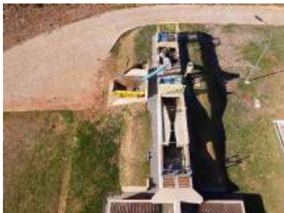
Figura 84: Sistema de Entrada de esgoto – Tratamento Preliminar
